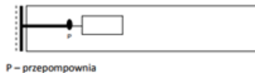
Rysunek 2. Kanalizacja ciśnieniowa
