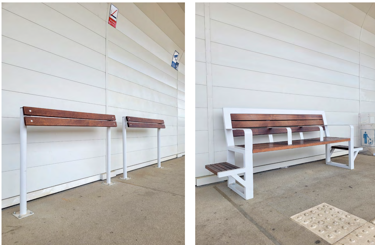
Ilustracja 29. Przykład zróżnicowanych siedzisk umożliwiających przyjęcie dogodnej pozycji podczas odpoczynku. Po lewej miejsce umożliwiające odpoczynek w pozycji półsiedzącej, po prawej ławka wyposażona w oparcie, podłokietniki oraz miejsce do odłożenia bagażu, fot. Katarzyna Guratowska
