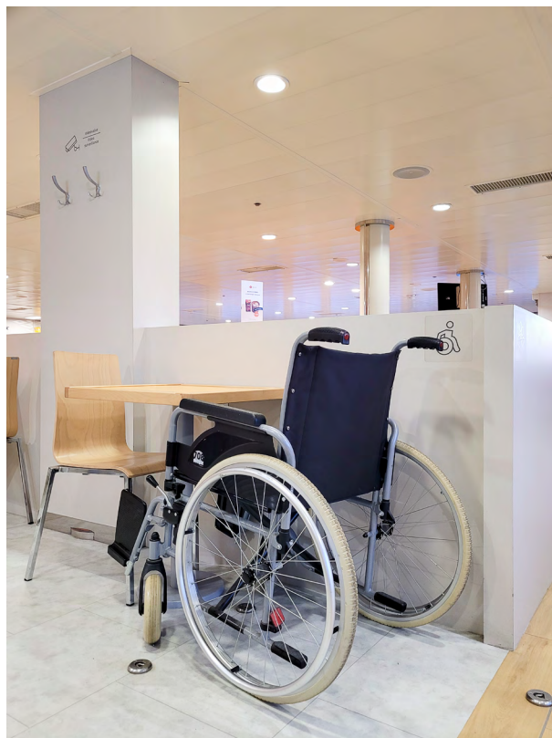
Ilustracja 20. Przykład miejsca przeznaczanego do bezpiecznego zaparkowania wózka na czas transportu na promie, fot. Katarzyna Guratowska
