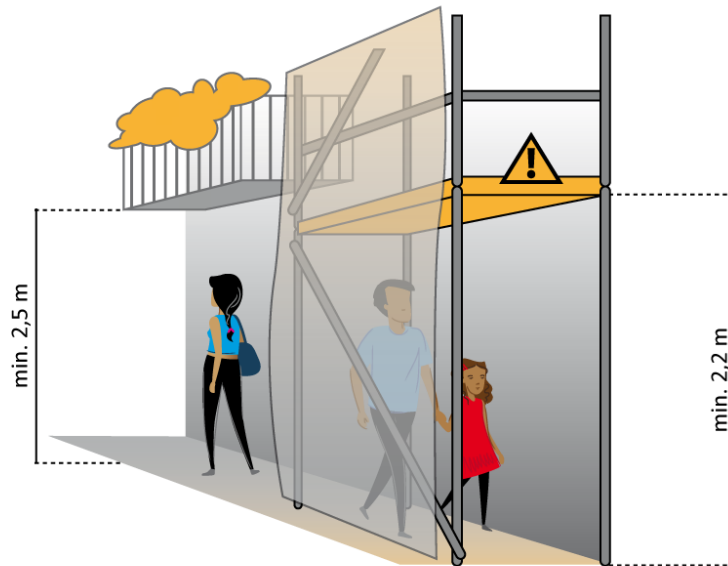
Ilustracja 32. Zasady umieszczania elementów tymczasowych nad ciągiem pieszym, rys. Maria Görlich-Opyd
